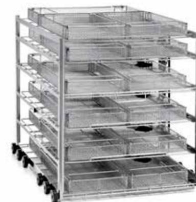
Carrello flessibile a 6 livelli con capacità fino a 18 cestini DIN. Dotato, nei livelli intermedi, di un braccio irroratore incorporato, mentre i livelli superiore ed inferiore sono serviti dagli irroratori presenti sul cielo e sul fondo vasca. Piani di lavaggio rimovibili per il trattamento di strumenti/oggetti con altezze differenti.
