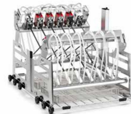
Carrello per lavare strumentazione serie Si 5-8mm usata da Robot Da Vinci. Dotato anche di n. 2 connessioni per il collegamento di sonde di controllo (una per ogni ramo collettore), sistema di bloccaggio, n. 2 micro-filtri (uno per ogni ramo collettore) e possibilità di alloggiare sul piano di fondo fino a 3 x CSKDIN (non inclusi). Disponibili anche in altre configurazioni.
