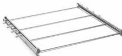
Carrello in acciaio inox con supporto telescopico per sistemi ad iniezione da posizionare sul 2° e/o 3° livello. Adatto al posizionamento dei sistemi ad iniezione (L685/L680/L690) che si agganciano direttamente alle sue guide. La sua flessibilità permette l'estrazione completa dei sistemi ad iniezione per un carico agevole della vetreria. Altezza massima delle vetrerie 390mm.
